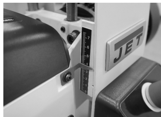
Figure 8-1: indicateur de profondeur
